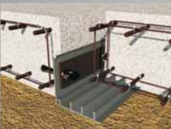
■ **stahlbewehrte Elastomerlager**
